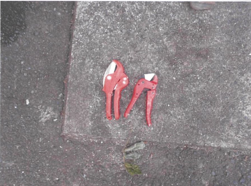
撮影項目 管の切断用 パイプカッター
