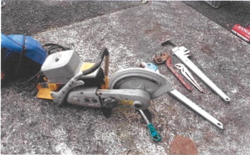
撮影項目 管の切断用
