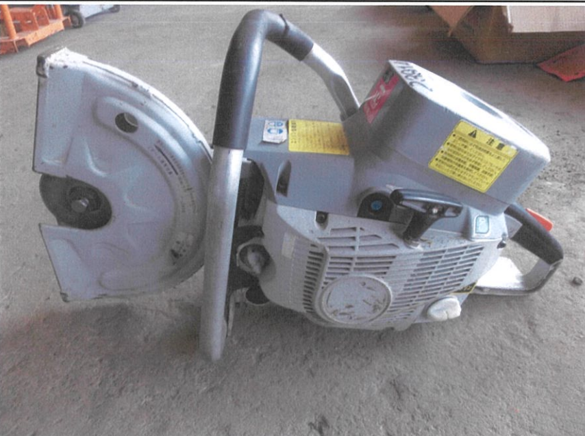
撮影項目 管の切断用 ハンドカッター
